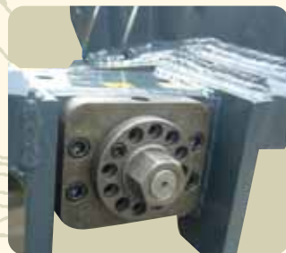
Sistema di regolazione per recupero giochi Adjustment system for clearance recovery Système de régulation pour le rattrapage des jeux
